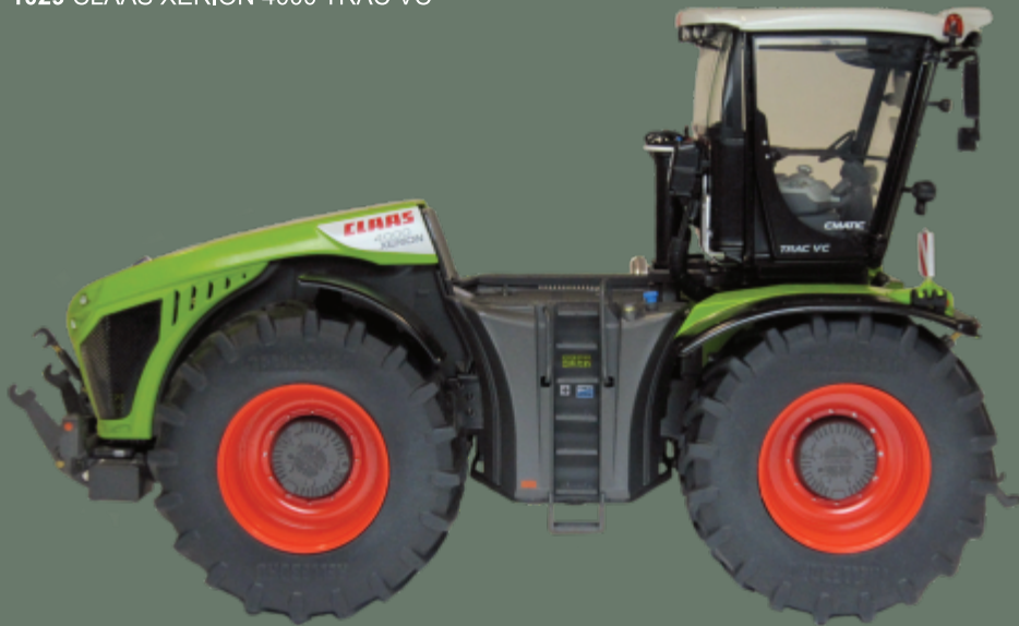
Seitenansicht mit um 180° nach hinten gedrehter Kabine.
